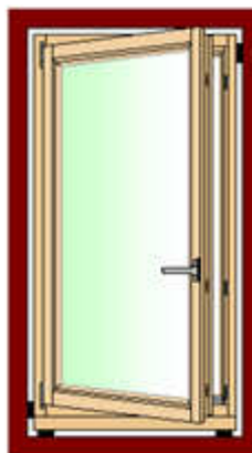
Beispiel: Anordnung der Tragklötze bei einem Dreh-Kipp-Fenster
