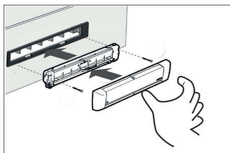
Die Grundplatte anschrauben und Frontblende aufsetzen und einrasten lassen.
