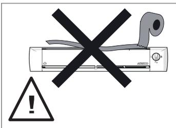
Verschließen Sie nie den ALD mittels Klebeband o.ä. : dies würde eine Frischluftzuführung verhindern und somit zur Verschlechterung der Innenraumluft (Schimmel, unangenehme Gerüche, usw.) führen.
